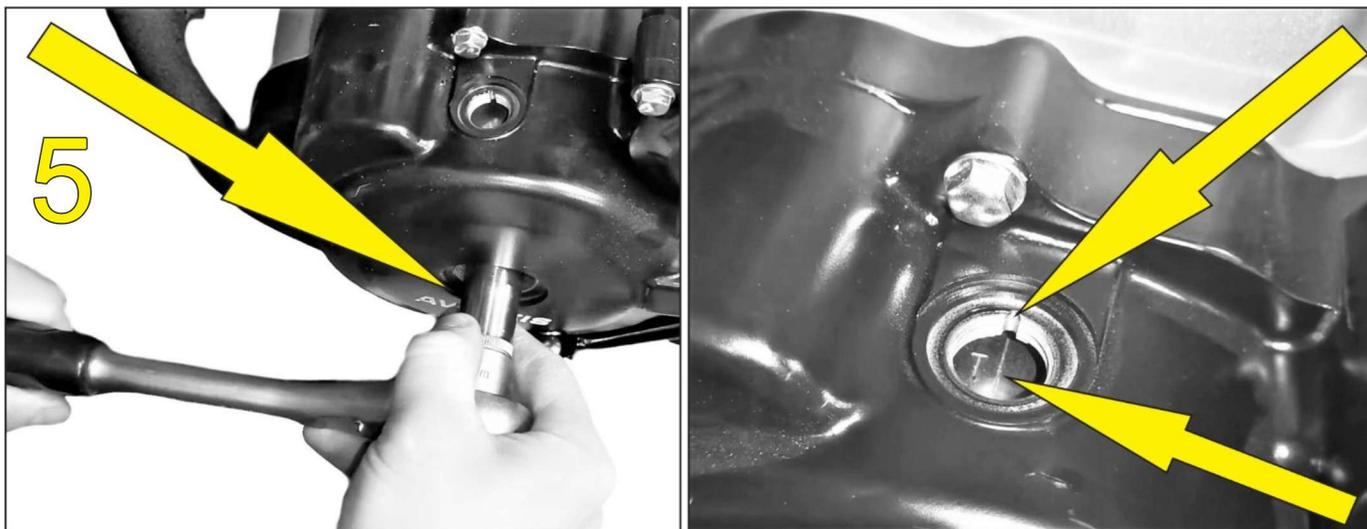
– Дополнительные метки ГРМ [7] находятся под крышкой в головке цилиндра на шестерне газораспределительного механизма [6]. механизма находятся метки, которые должны совпасть аналогично нижним меткам ротора генератора.
